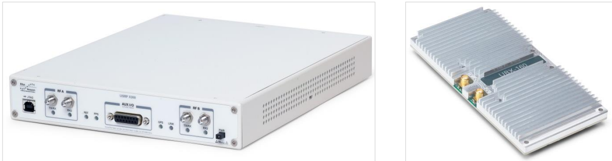
Abbildung 4-1: Software Radio Plattform (links); analoges Daughterboard (rechts)
